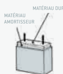
LES DEUX PLAQUETTES SONT ENFILÉES SUR DEUX CÂBLES ET NON COLLÉES
