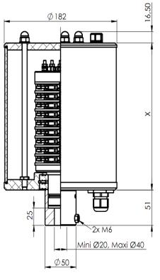
Nombre de pistes : 16 maxi Courant admissible: 25 A 400 V AC Tension nominale: 2500 V Tension d'isolement : Classe d'isolement : Classe 1 IP54 Indice de protection : Température d'utilisation : -25/+60°C jusqu'à 95 % Humidité relative : Vitesse de rotation maxi: 100 tr/min
